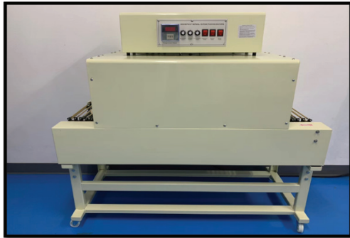
ภาพที่ 5 เครื่องอัดฟิล์มหด
