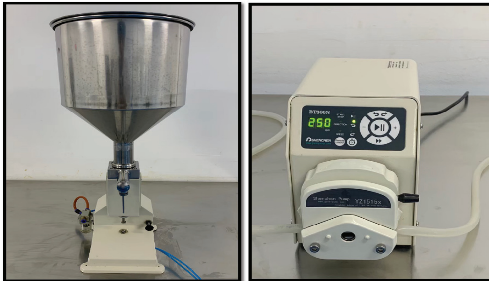
ภาพที่ 2 เครื่องบรรจุครีม และเครื่องดูดของเหลว
