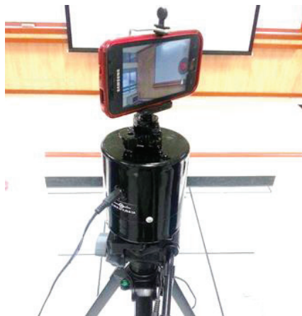
ภาพที่ 6 ฐานกล้องอัจฉริยะที่ติดตั้งเรียบร้อยแล้วเพื่อการทดสอบ
