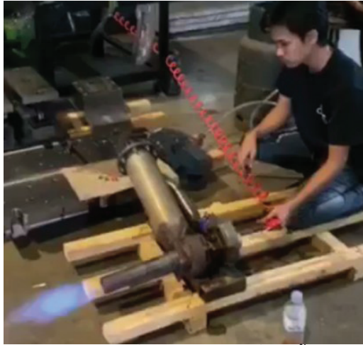
ภาพที่ 4 ภาพการทดสอบการทำงานของเครื่องยนต์อัดอากาศที่สร้างขึ้นโดยใช้แก๊ส LPG เป็นเชื้อเพลิง
