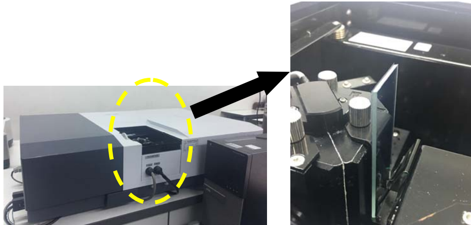
ภาพที่ 2 การวางแผ่นกระจกสไลด์ลงบนแท่นเครื่องยูวี-วิสิเบิล-เนียร์ไออาร์ สเปกโตรโฟโตมิเตอร์
