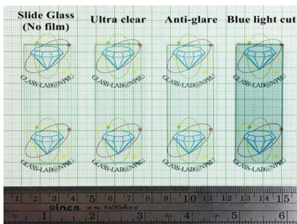
ภาพที่ 1 กระจกสไลด์แบบไม่ติดฟิล์ม แบบติดฟิล์มใส แบบติดฟิล์มด้าน และแบบติดฟิล์มตัดแสงสีน้ำเงิน
