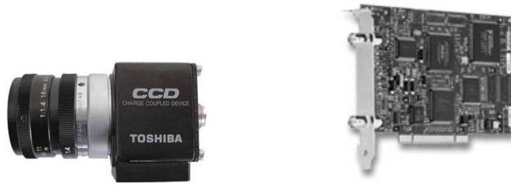
ภาพที่ 3 กล้องตรวจจับภาพ Toshiba IK-C44H และการ์ด NI 1405
