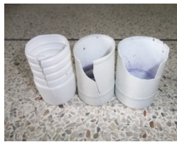
รูปภาพที่ 1 ลักษณะกระบอกที่แตกเสียหาย
