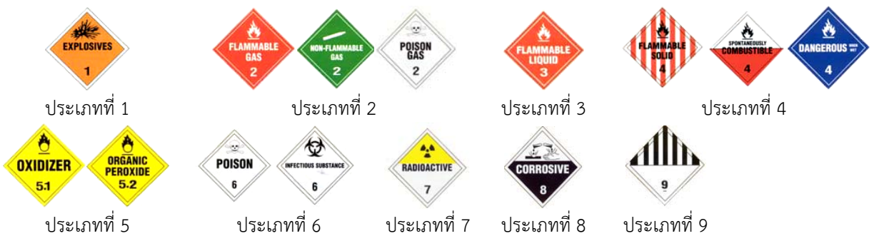
รูปภาพที่ 1 สัญลักษณ์แสดงอันตรายของสารเคมีตามระบบ UN
