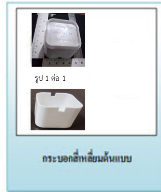
รูปภาพที่ 6 ต้นแบบแม่พิมพ์ขึ้นรูปกระบอกพลาสติกทรงสี่เหลี่ยม
