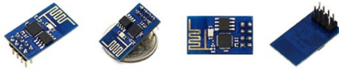
รูปภาพที่ 3 ESP-01 โมดูลสื่อสารข้อมูลอนุกรมไร้สายผ่าน WiFi (ESP8266EX)
