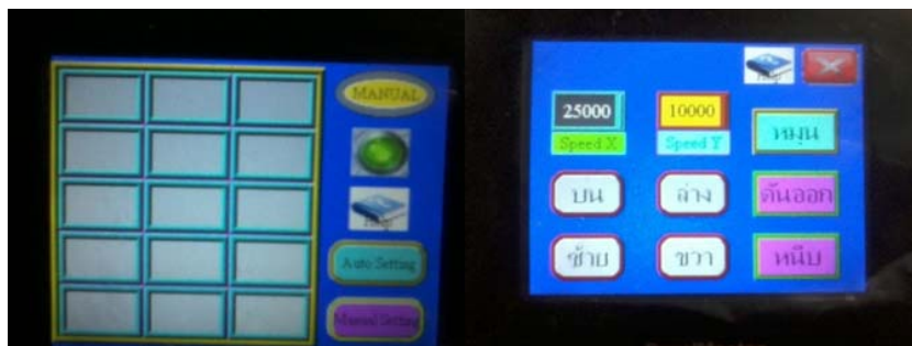
รูปภาพที่ 7 การเข้าใช้งานหน้าต่างการสั่งการทำงานระบบสั่งงานด้วยมือ
