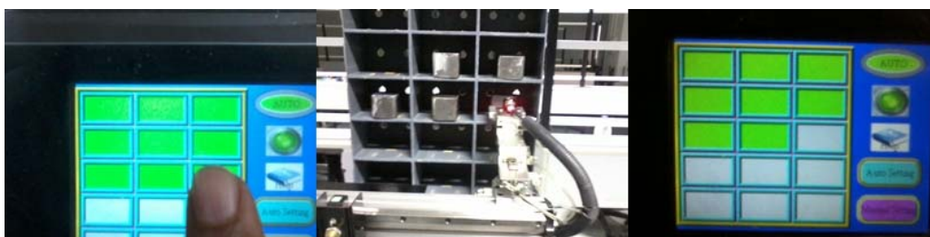
รูปภาพที่ 10 การสั่งจับชิ้นงานด้วยระบบอัตโนมัติจำนวน 7 ช่อง
