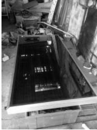
รูปภาพที่ 2 ตัวเก็บรังสีอาทิตย์ (sola collector)
