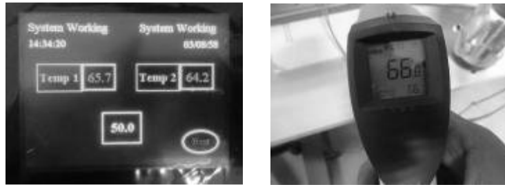
รูปภาพที่ 7 แสดงอุณหภูมิของน้ำร้อนระหว่างพีที100กับเทอร์โมมิเตอร์
