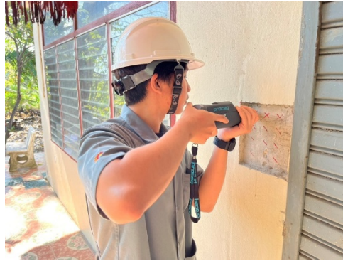
ภาพที่ 1 การทดสอบเพื่อหาค่ากำลังอัดคอนกรีตด้วยชนิดต์แฮมเมอร์
