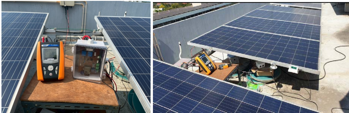
ภาพที่ 4 การทดสอบการวัดประสิทธิภาพเซลล์แสงอาทิตย์เปรียบเทียบกับเครื่องมือ HT รุ่น PVCHECKS
