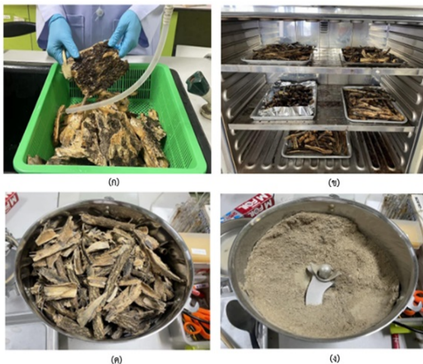
ภาพที่ 1 การเตรียมเปลือกต้นมะขวิด (ก) ล้างน้ำให้สะอาด (ข) อบให้แห้ง (ค) ใสในเครื่องบด และ (ง) บดละเอียด
