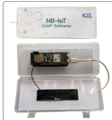
ภาพที่ 7 อุปกรณ์เฝ้าระวังและตรวจสอบสถานะการทำงานของสวิทช์เพื่อส่งข้อมูลไปยังคลาวด์
