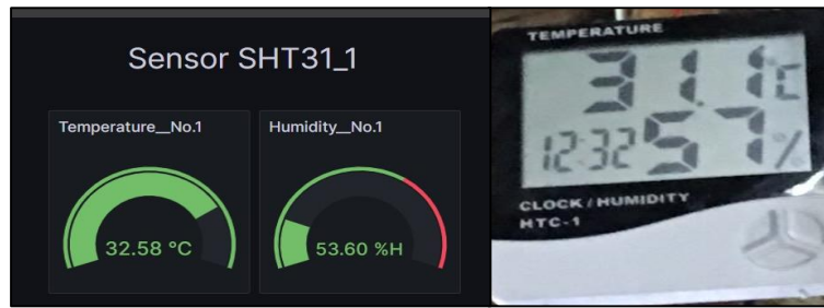
ภาพที่ 9 ภาพเปรียบเทียบเซนเซอร์วัดอุณหภูมิและความชื้นกับเครื่องวัดอุณหภูมิและความชื้นมาตรฐาน
