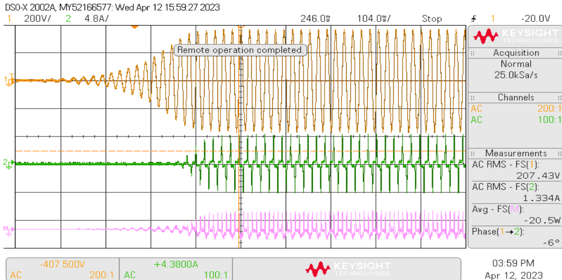
ภาพที่ 4 ปรากฏการณ์การกระตุ้นด้วยตัวเองของเครื่องกำเนิดไฟฟ้าเหนี่ยวนำกระตุ้นด้วยตัวเอง
