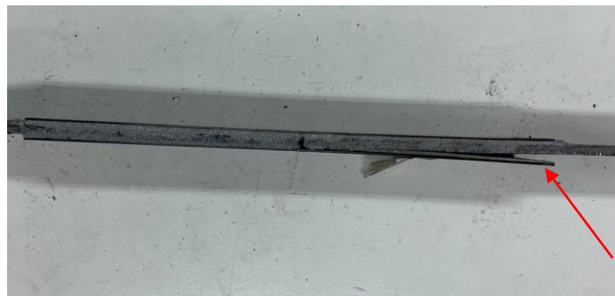
ภาพที่ 5 การหลุดออกระหว่างแผ่นเหล็กกับกาวประสานในตัวอย่าง SP-45-80
