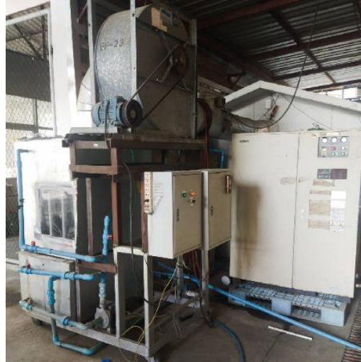
ภาพที่ 1 โรงเพาะเห็ดทดสอบและระบบสร้างอากาศเย็น
