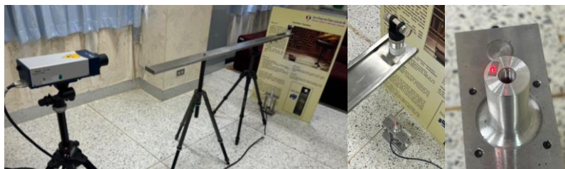
ภาพที่ 5 การวัดการสั่นของโซโนโทรดด้วยเครื่อง laser doppler vibrometer
