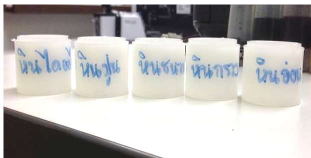
รูปภาพที่ 1 การเตรียมตัวอย่างหินที่จะทำการวัดด้วยเครื่องเอกซ์เรย์ฟลูออเรสเซนซ์สเปกโตรมิเตอร์
