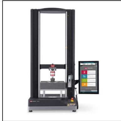
ภาพที่ 1 เครื่อง Universal Testing Machine; Instron model 68TM - 30 ที่มา: [6]
