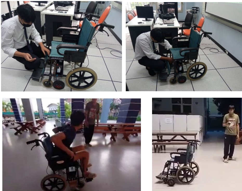
ภาพที่ 6 ผลการพัฒนาระบบต้นแบบรถเข็นผู้ป่วยที่ขับเคลื่อนด้วยชุดอุปกรณ์อินเทอร์เน็ตของสรรพสิ่ง และควบคุมด้วยเสียง
