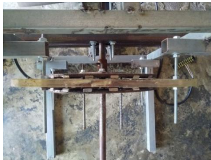
ภาพที่ 10 เครื่องกำเนิดไฟฟ้าเส้นแรงแม่เหล็กตามแนวแกนแบบแม่เหล็กถาวรที่สร้างขึ้น
