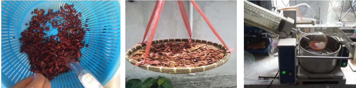
ภาพที่ 1 การเตรียมสารสกัดจากเปลือกมังคุดโดยใช้เครื่อง rotary evaporator
