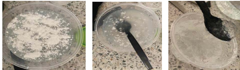
ภาพที่ 19 เตรียมเจลโดยเริ่มจากการละลาย Carbopol 940 ในน้ำสะอาด คนจนเป็นเนื้อเดียวกันและเติม Tri Ethanolamine (TEA) คนให้เข้ากันจนเริ่มเป็นเนื้อเจลเหลวใส
