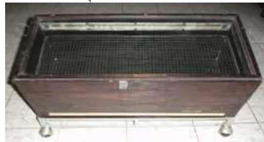
(ง) ตู้อบแห้งแสงอาทิตย์แบบที่ 2 ขณะวางบนขาตั้ง
