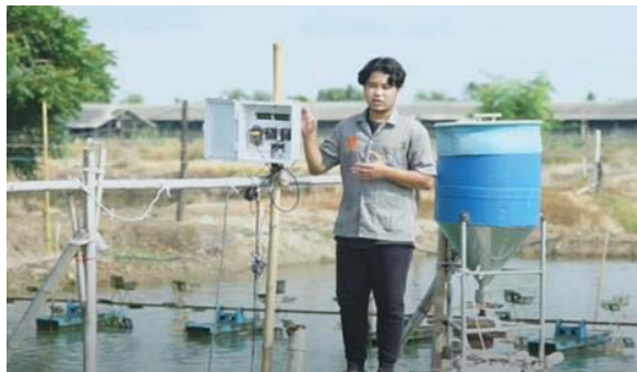
ภาพที่ 16 บ่อที่ใช้ในการทดลองวางระบบวัดค่าออกซิเจนละลายในน้ำ อุณหภูมิ น้ำ และค่ากรด-ด่าง
