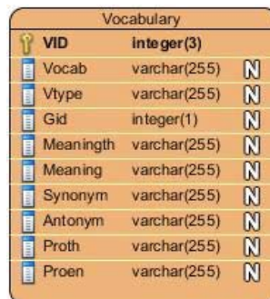
ภาพที่ 4 แผนภาพ Entity-Relationship Diagram
