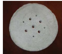
ภาพที่ 1 วัสดุบด แบ่งทดลองและผลิตภัณฑ์แผ่นคอร์เตียไรท์ทนความร้อนสูง สูตรที่ 1 ทิมา (สฤชนม์ พรหมสายใจ, 2563)
