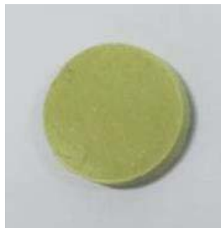
ภาพที่ 2 สารประกอบออกไซด์ของอินเดียมเจือด้วยออกไซด์ของดีบุก 10 เปอร์เซ็นต์โดยน้ำหนัก ที่ผ่านการอบผนึกที่อุณหภูมิ 1,300 องศาเซลเซียส เป็นเวลานาน 3 ชั่วโมง
