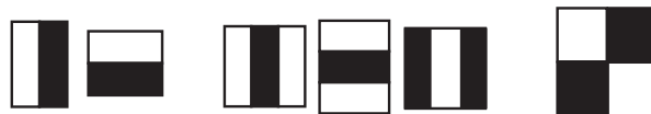
ภาพที่ 1 ตัวจำลองรูปแบบ Harr-like feature
