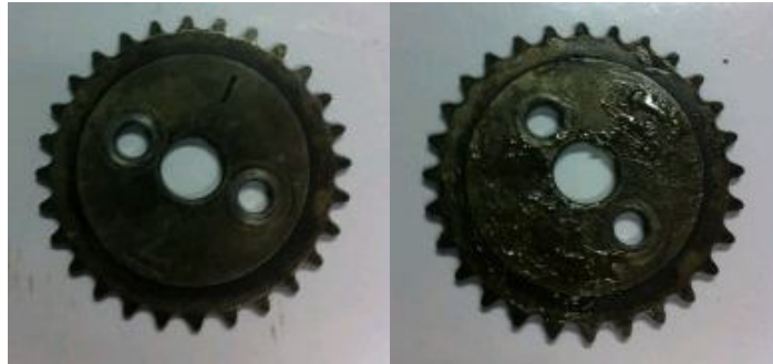
ภาพที่ 10 การเตรียมชิ้นงานที่ใช้ทดสอบในการทำความสะอาด
