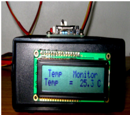
รูปภาพที่ 5 ค่าอุณหภูมิที่อ่านได้จอแสดงผลแอลซีดีของชุดวัดอุณหภูมิและค่าที่แสดงบนคอมพิวเตอร์
