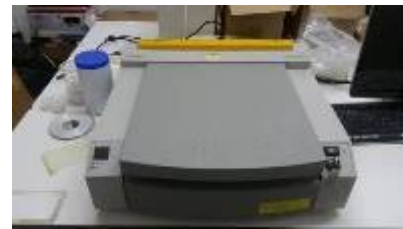
ภาพที่ 2 เครื่องวิเคราะห์ X-ray fluorescence spectrometry (XRF)
