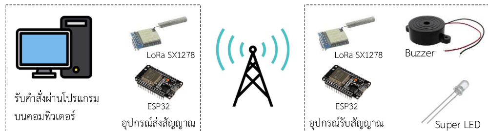
ภาพที่ 1 ภาพรวมหลักการทำงานของอุปกรณ์ระบุตำแหน่งแบบไร้สายด้วยเทคโนโลยี LoRa ร่วมกับระบบประหยัดพลังงาน
