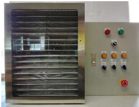
ภาพที่ 4 ต้นแบบเครื่องอบแห้งซึ่งด้วยลมร้อนแบบกึ่งอัตโนมัติด้วยเทคโนโลยี IoT
