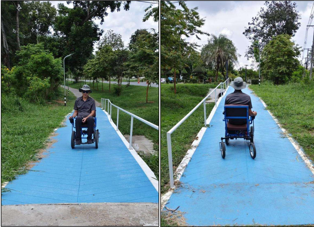
ภาพที่ 7 ทดสอบต้นแบบวีลแชร์ไฟฟ้า ขึ้นลงบนทางเดินลาดเอียง
