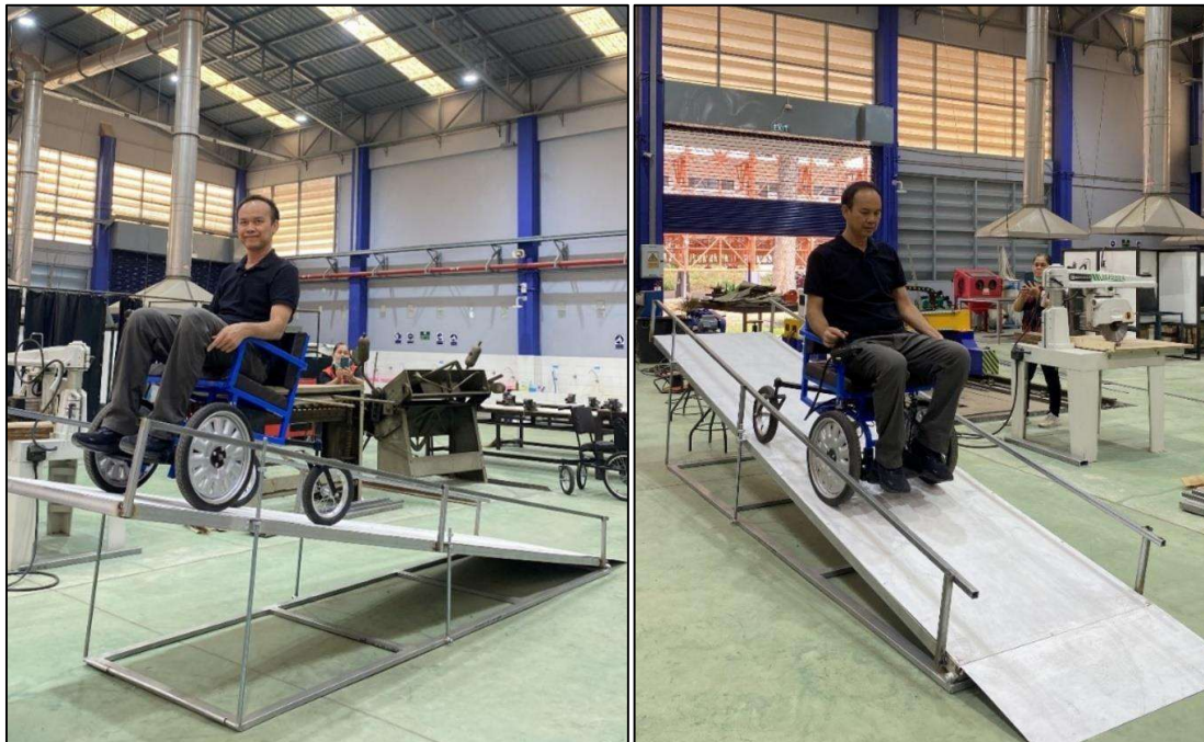
ภาพที่ 3 ทดสอบต้นแบบวีลแชร์ไฟฟ้า ขึ้นลงบนทางลาดชัน ปรับองศาได้
