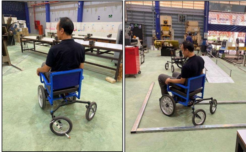
ภาพที่ 4 ทดสอบรีมิ่งเลี้ยว และการเคลื่อนที่ผ่านเส้นทางมุมฉากของต้นแบบวีลแชร์ไฟฟ้า
