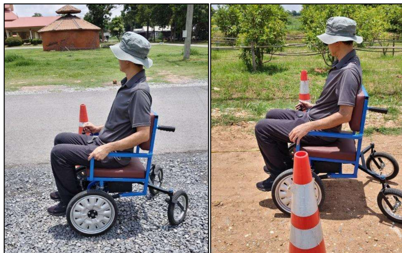
ภาพที่ 6 ทดสอบต้นแบบวีลแชร์ไฟฟ้า บนถนนหินคลุกและถนนดินลูกรัง
