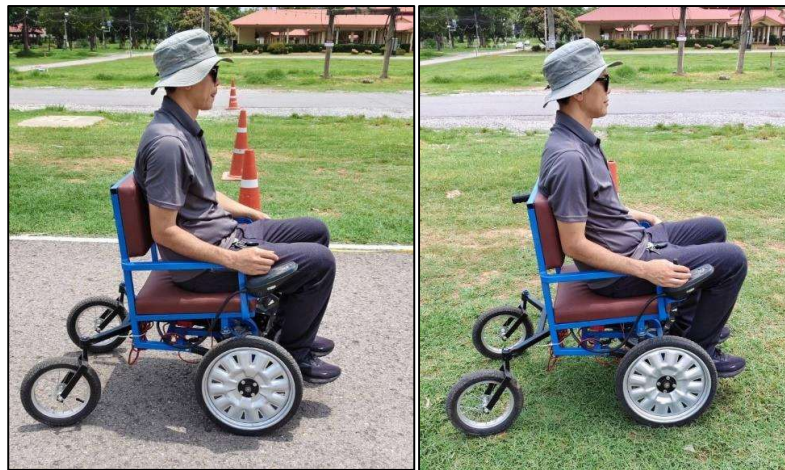
ภาพที่ 5 ทดสอบต้นแบบวีลแชร์ไฟฟ้า บนถนนลาดยางมะตอยและสนามหญ้า
