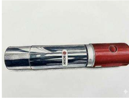
ภาพที่ 2.2 หัววัดรังสีแบบซินเทิลเลชัน NaI(Tl) ยี่ห้อ Canberra (Model 802-2X2) ที่ใช้ในการทดลองวัสดุลดทอน (Absorbers)
