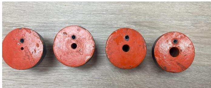
ภาพที่ 2 แสดงคอลลิเมเตอร์ที่มีขนาด 4, 7, 9 และ 13 มิลลิเมตร
