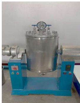
ภาพที่ 1 เครื่องย่อยเยื่อระดับห้องปฏิบัติการ(Laboratory rotary pulp digester)
