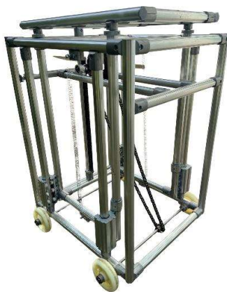
ภาพที่ 3 แบบจำลองสามมิติ (3D Model) ของเครื่องจักรกลช่วยยกโดยใช้หลักการคาราคูรี
