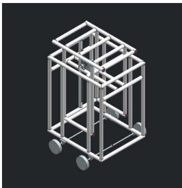
ภาพที่ 3 แบบจำลองสามมิติ (3D Model) ของเครื่องจักรกลช่วยยกโดยใช้หลักการคาราคูรี
