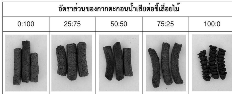
ภาพที่ 6 ภาพเชื้อเพลิงชีวมวลอัดเม็ดจากกากตะกอนน้ำเสียต่อขี้เลื่อยไม้ในอัตราส่วนต่าง ๆ
