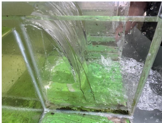
(ก) ภาพด้านข้างของการไหลของน้ำข้ามสันฝาย
