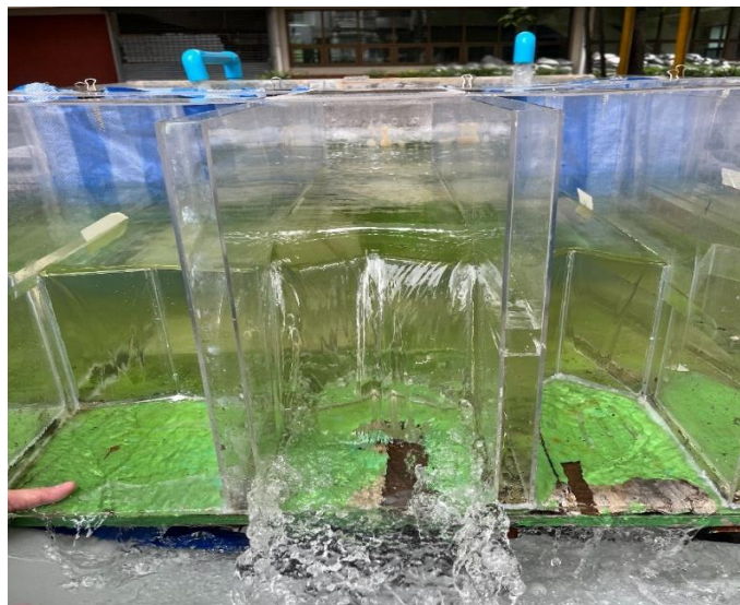
(ข) การไหลกลับของน้ำข้ามสันฝายเมื่อสังเกตจากทางด้านท้ายน้ำ
