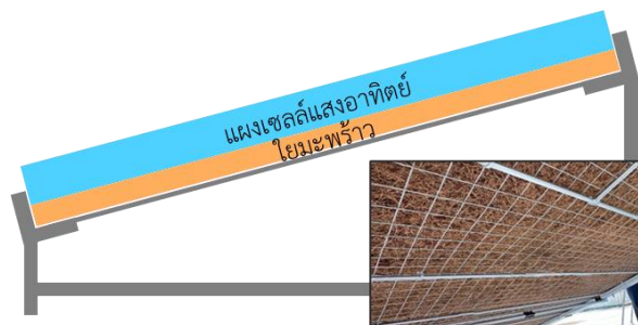
ภาพที่ 1 แผงเซลล์แสงอาทิตย์ที่มีการทำความเย็นแบบระเหยด้วยแผ่นไยมะพร้าวกับแผงอั้งอิง
