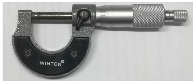
ภาพที่ 2 เครื่องไมโครมิเตอร์ (micrometer)
