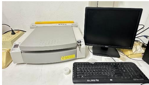
ภาพที่ 4 เครื่อง X-rays fluorescence spectrometer (XRF) (Minipal-4, Panalytical)
