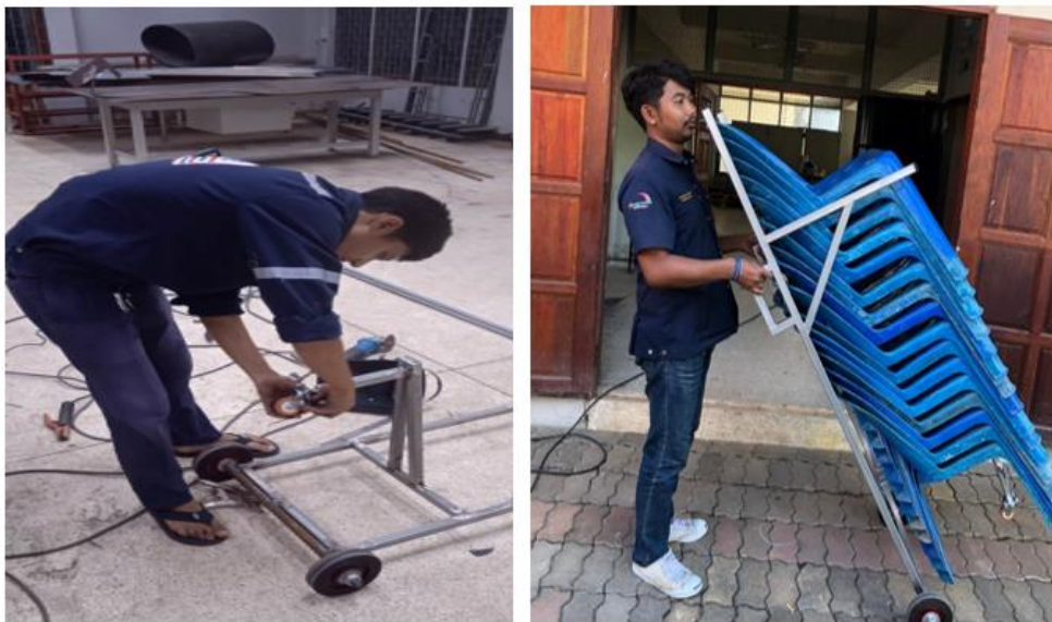
ภาพที่ 6 การสร้างและการทดลองรถเข็นขนย้ายเก้าอี้
