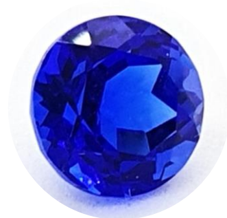
2. แก้วที่เติม CoO ที่ความเข้มข้น 0.04 ร้อยละโดยโมล
