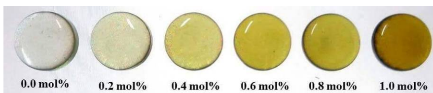
รูปภาพที่ 1 ลักษณะของแก้วตัวอย่างที่เติม \text{Fe}_2\text{O}_3 ที่ได้จากการหลอมแก้ว (40-x)\text{SiO}_2 : 10\text{B}_2\text{O}_3 : 25\text{Na}_2\text{O} : 8\text{CaO} : 5\text{ZrO}_2 : 1\text{Bi}_2\text{O}_3 : 0.5\text{TiO}_2 : 0.5\text{Al}_2\text{O}_3 : 10\text{BaO} : \text{xFe}_2\text{O}_3
