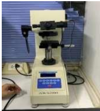
ภาพที่ 5 เครื่องทดสอบความแข็งแบบดิจิตอลไมโครวิกเกอร์ (รุ่น HVS-1000 digital micro vickers hardness taster)
