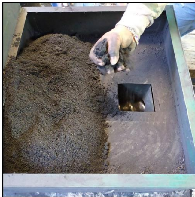
ภาพที่ 5 ขั้นตอนเตรียมตัวอย่างชีวมวลอัดแท่ง “เมื่อความชื้นของผงถ่านไม้ที่ผสมดีแล้ว ให้นำเข้าเครื่องทำถ่านอัดแท่ง”
