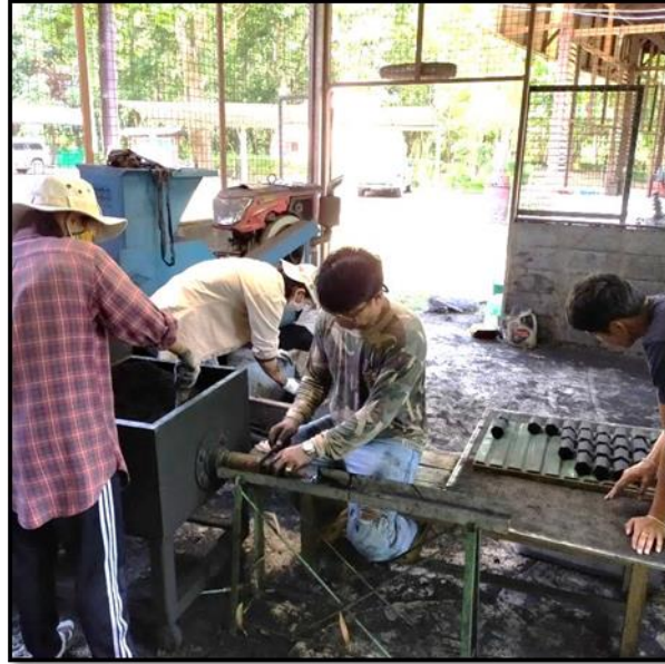
ภาพที่ 6 ขั้นตอนเตรียมตัวอย่างชีวมวลอัดแท่ง “นำไปอัดให้เป็นแท่งด้วยเครื่องอัดขึ้นรูปเชื้อเพลิงถ่านอัดแท่ง”
