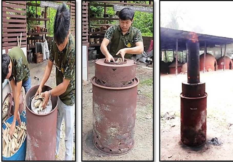
ภาพที่ 2 ขั้นตอนเตรียมตัวอย่างชีวมวลอัดแท่ง “เผาให้เป็นถ่านด้วยเตาถังน้ำมัน 200 ลิตรแบบเตาไร้ควันของกรมป่าไม้”
