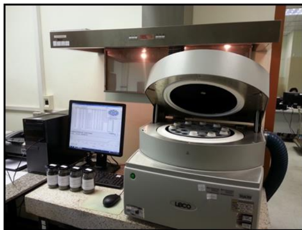
ภาพที่ 7 วิเคราะห์ Proximate Analysis ด้วยเครื่อง TGA รุ่น TGA-701
