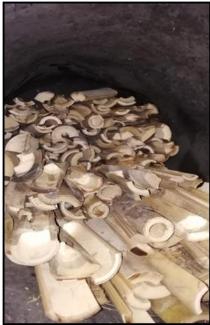
ภาพที่ 1 ขั้นตอนเตรียมตัวอย่างชีวมวลอัดแท่ง “นำลำไม้ไผ่มาเลื่อยเป็นท่อนๆขนาด 10-15 เซนติเมตร”
