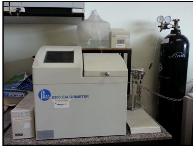
ภาพที่ 8 วิเคราะห์ค่าพลังงานความร้อนแบบบรอส ด้วยเครื่อง Bomb Calorimeter รุ่น PARR-6300
