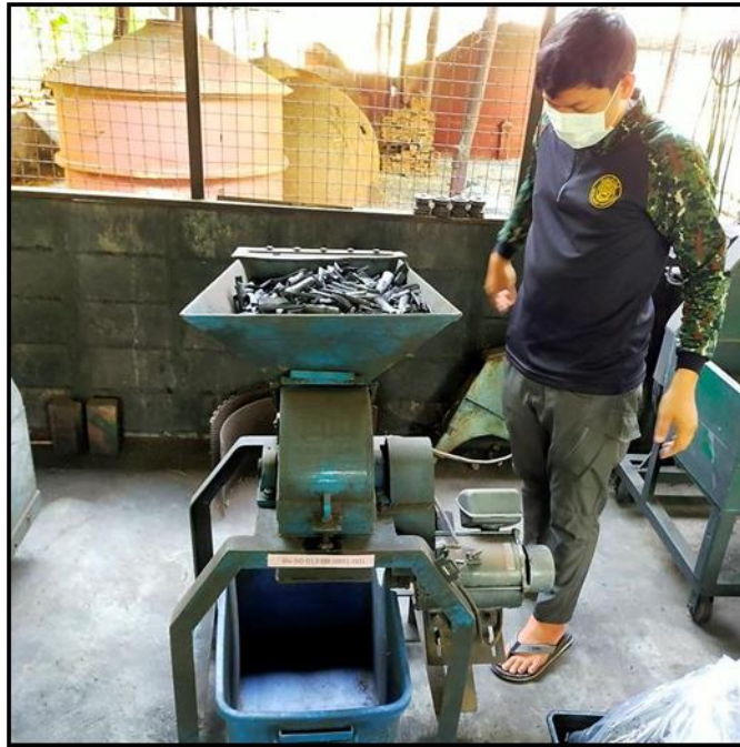
ภาพที่ 4 ขั้นตอนเตรียมตัวอย่างชีวมวลอัดแท่ง “นำถ่านไม้ไฟที่ได้จากการคัดแยกไปบดให้ละเอียดด้วยเครื่องบดย่อย”
