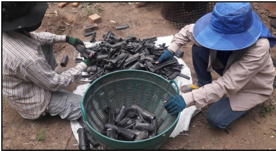
ภาพที่ 3 ขั้นตอนเตรียมตัวอย่างชีวมวลอัดแท่ง “แยกส่วนที่เป็นถ่านออกจากส่วนที่ยังไม่เป็นถ่านโดยสมบูรณ์ (เป็นเส้นถ่าน)”
