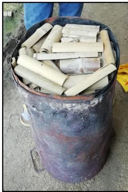
ภาพที่ 1 ขั้นตอนเตรียมตัวอย่างชีวมวลอัดแท่ง “นำลำไม้ไผ่มาเลื่อยเป็นท่อนๆขนาด 10-15 เซนติเมตร”
